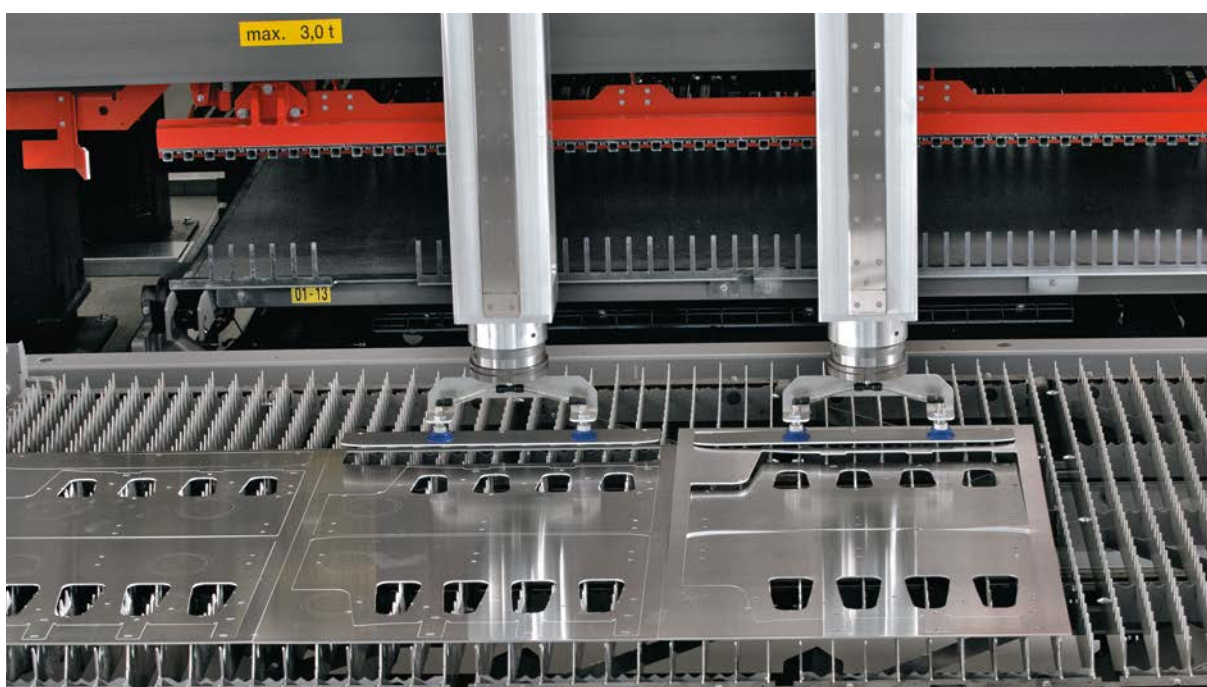
Laserskärning av plåt med robotplockning
