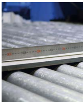
Plåt före planriktning
