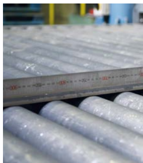
Plåt efter planriktning
