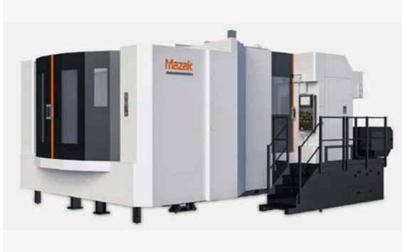
Horisontell fleroperationsmaskin Maximalt bearbetningsområde: 1,7x1,4x1,5 meter (120 olika verktyg)
