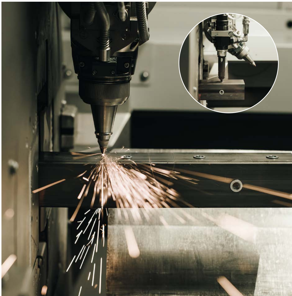
Rörlaserskärning med fast skärhuvud och montering av blindnitmutter
