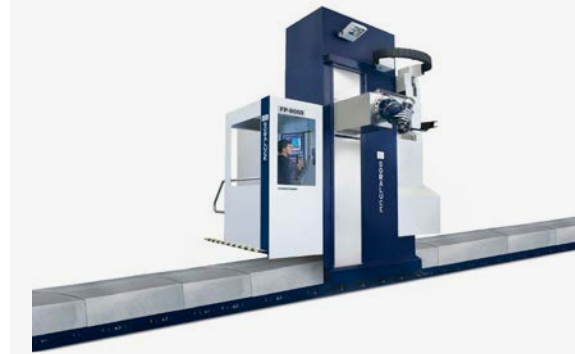
Bäddfräs Maximalt bearbetningsområde: 8x2,6x1,3 meter
